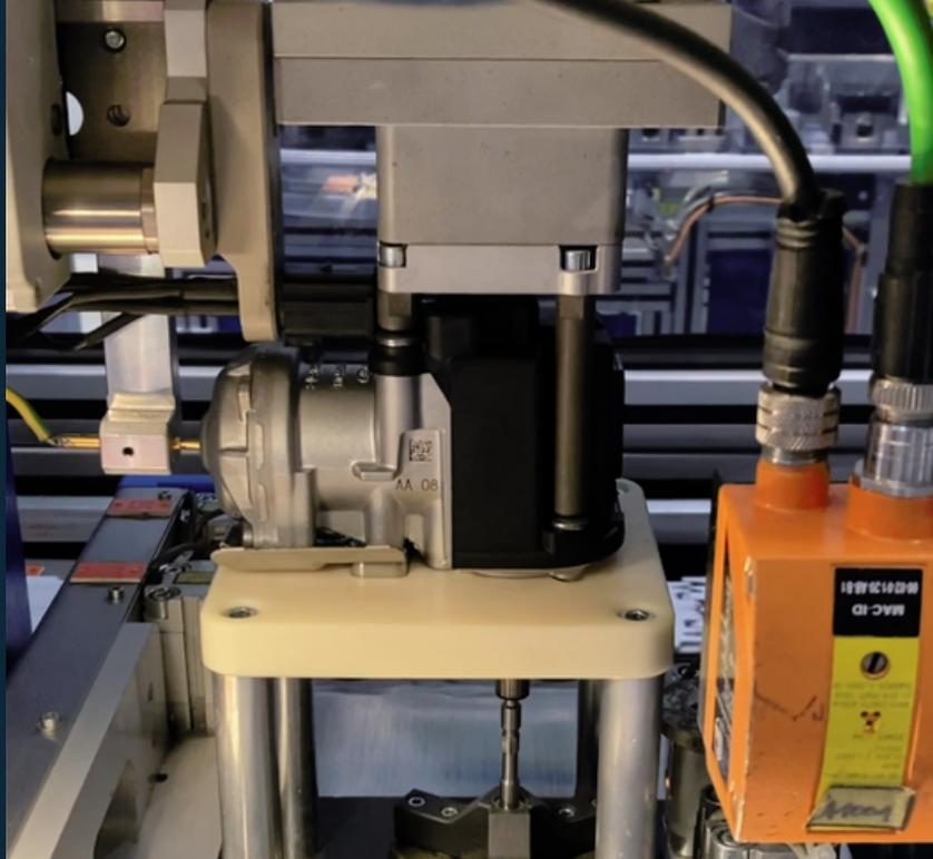
MAHLE hat Selmo mit der Modernisierung einer Prüfstation für die Qualitätskontrolle einer Produktionslinie beauftragt. Das Ziel war es, die bestehende Anlage zu erhalten, aber die komplexe und anfällige Steuerung zu ersetzen. Durch die Inbetriebnahme der neuen Steuerung konnte der Prozessablauf optimiert und die Taktzeit verbessert werden.
